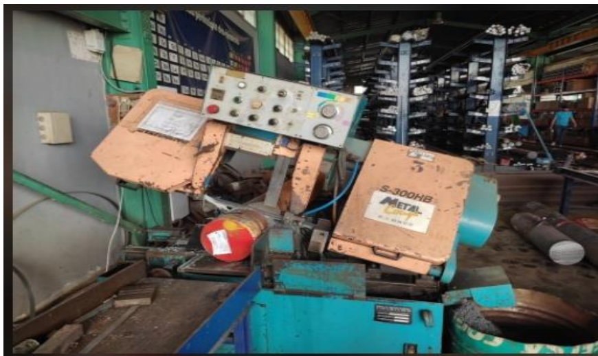
Figure III.2 :l'opération de découpage ....(SCIES ARUBAN)
