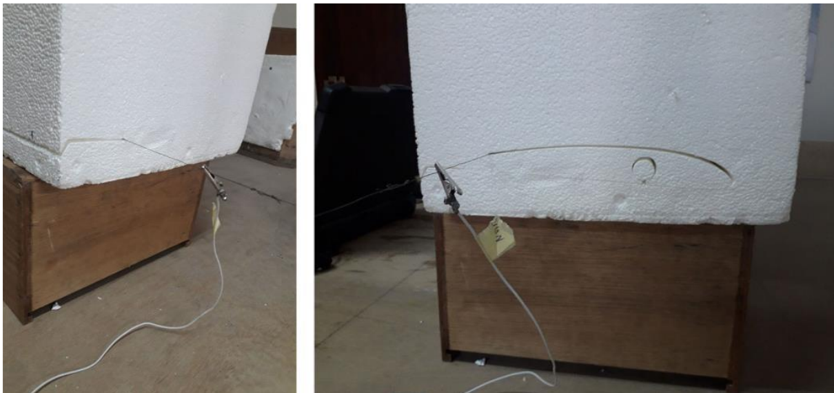
Figure II.9. Trajectoire du fil durant l'usinage
