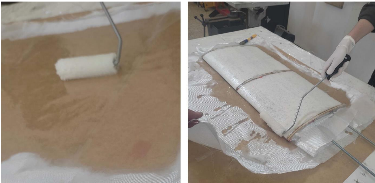
Figure II.13. Revêtement de l'aile .
