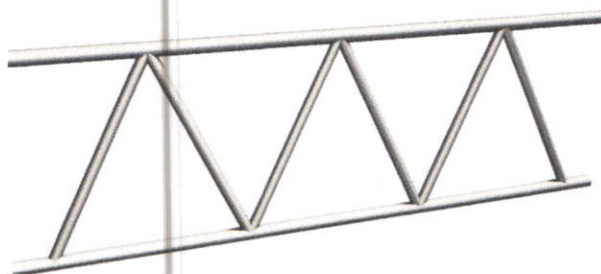
Figure 45 : Poutre en treillis
