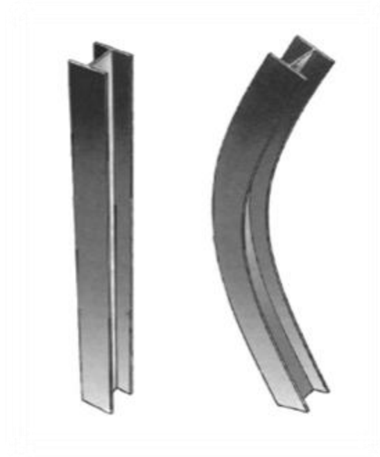
Figure V.1 : Phénomène du flambement
