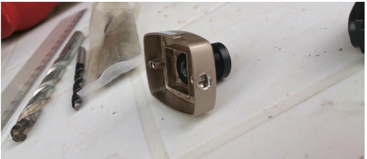
Figure III-5 Le perçage du cadre de la caméra
