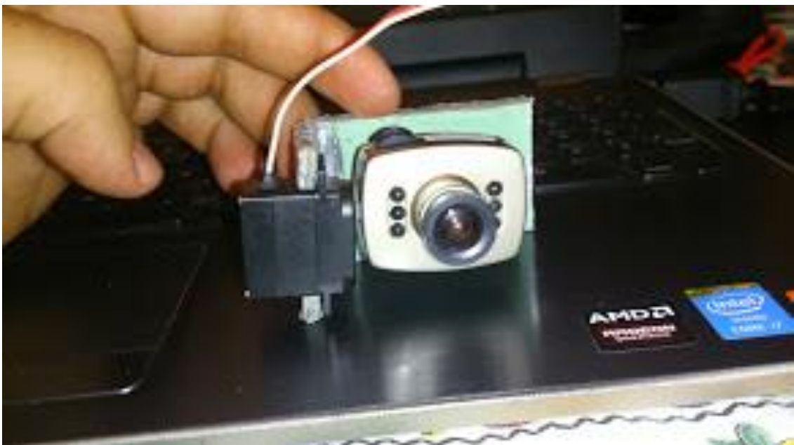
Figure III-7 La mise en place du servomoteur1+camera + cadran
