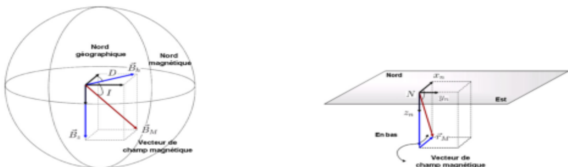
Figure II-7 (gauche) Champ magnétique terrestre, (droite) Champ magnétique dans le repère NED
