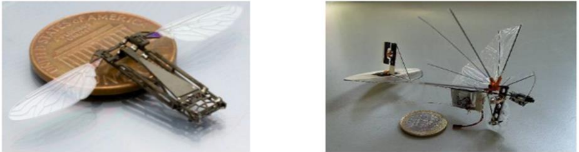
Figure I-19 : Exemples de drones insectes [4]
