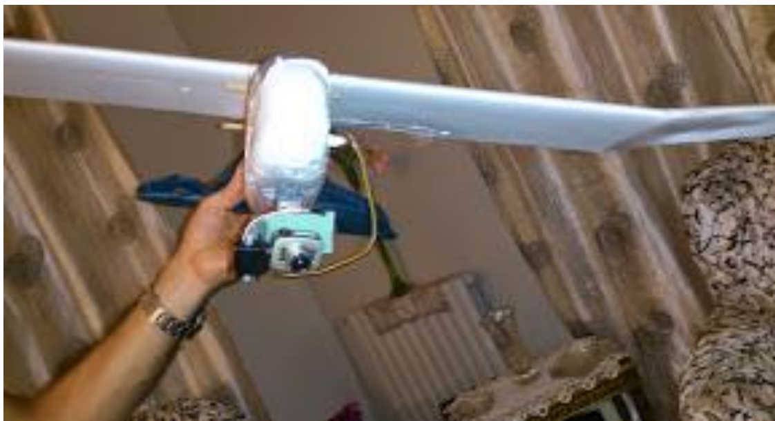
Figure III-9 Mise en place du Gimbal sur le drone.
