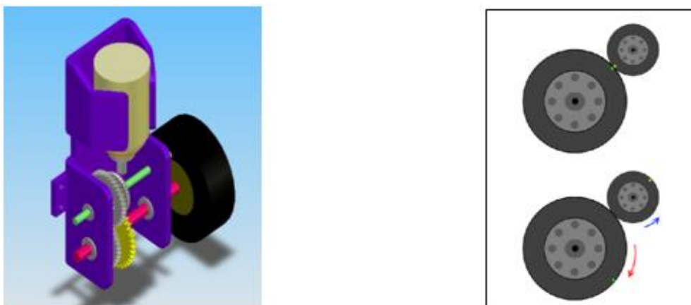
Figure II-11 moteur + réducteur + roue [23]
