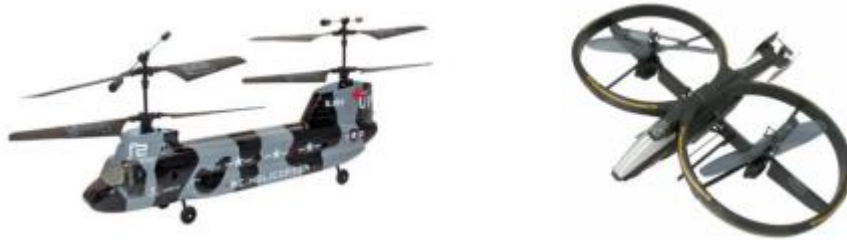
Figure I-II-14 : Exemples d'hélicoptères miniatures à rotors en tandem [4]
