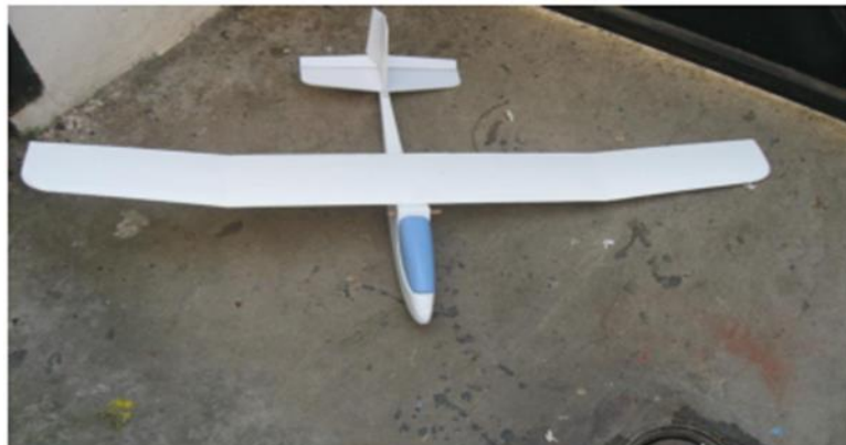
Figure I-20 : L'assemblage complet du BR-50 [6].
