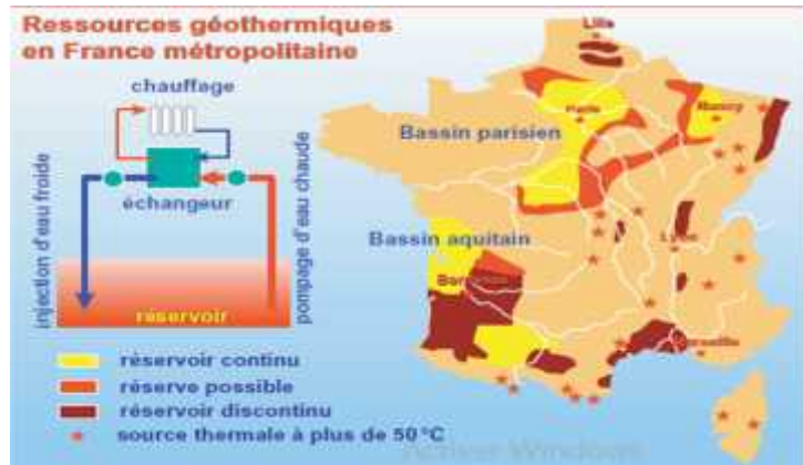
Figure 6: Schéma de principe et carte des ressources géothermique française. Source: liébard et de herde, 2005
