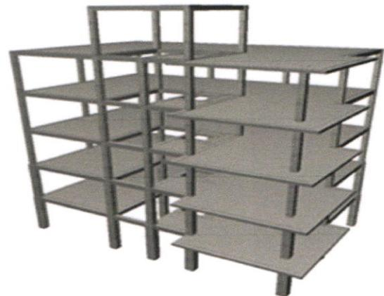
Fig: Schéma d'une ossature poteau-poutre
