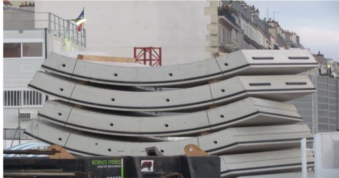
**Figure II.13:Exemple des voussoirs préfabriqué.**
