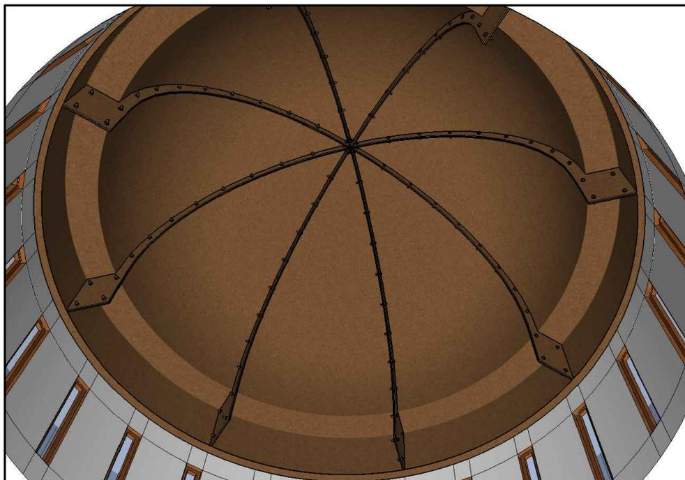
**Fig 02** : Vue sur la structure de coupole (notre projet)
