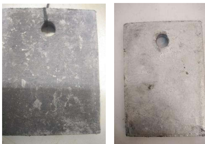
Figure III 13. Dépôt de zinc galvanisé de 60 \mu\text{m} avant et après l'essai de corrosion.
