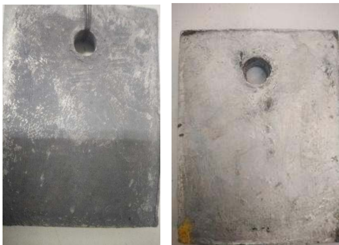
Figure III 12. Dépôt de zinc galvanisé de 42 \mu\text{m} avant et après l'essai de corrosion.
