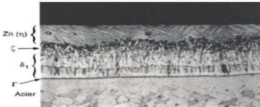
Figure I. 4. Vue en coupe transverse de phases formées après la galvanisation de l'acier. [5]
