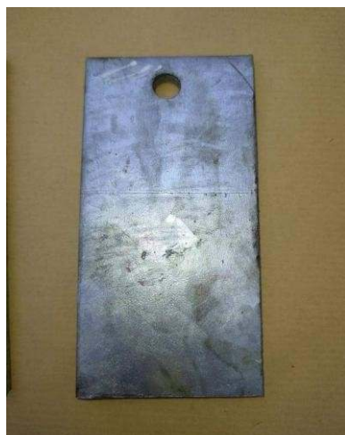
Figure III 3. Plaque polie avec papier émeri de 80 / 220 et galvanisée durant une minute.
