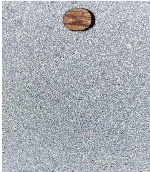
Figure III 10. Revêtement de zinc déposé par projection thermique
