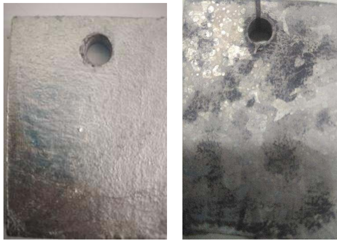
Figure III 14. Dépôt de zinc galvanisé de 76 \mu\text{m} avant et après l'essai de corrosion.
