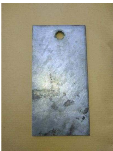
Figure III 5. Plaque polie avec papier émeri de 80/220/600/1200 et galvanisée durant une minute.
