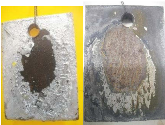
Figure III 11. Dépôt de zinc galvanisé de 6 \mu\text{m} avant et après l'essai de corrosion
