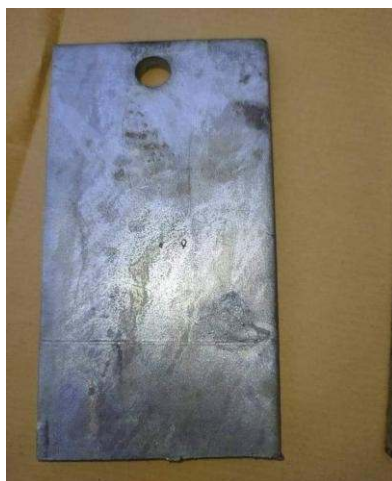
Figure III 2. Plaque polie avec papier émeri de 80 et galvanisée durant une minute.
