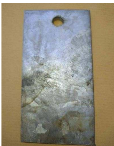
Figure III 4. Plaque polie avec papier émeri de 80/220/600 et galvanisée durant une minute.
