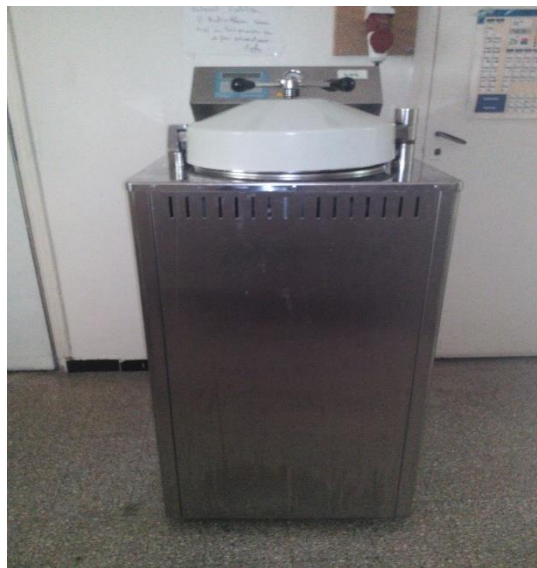
Figure n° 30 : stérilisation du matériel de culture dans L'autoclave
