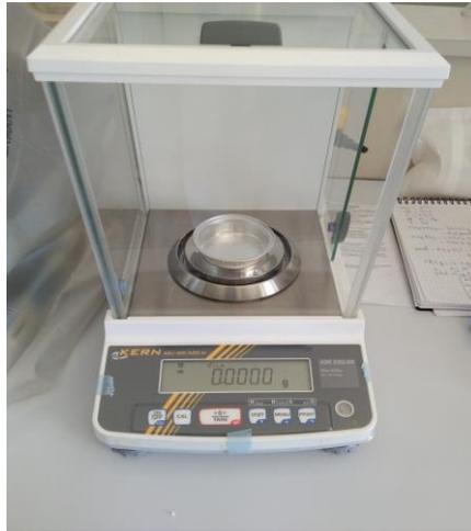
**Figure 20** : La balance dont la capacité maximale est de 220g.
