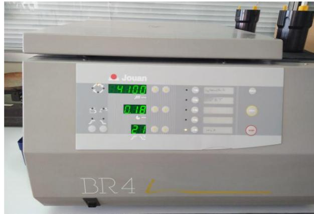
**Figure 18** : La centrifugeuse dotée d'une capacité de 4100 tours/minutes.
