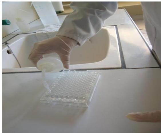
**Figure 6 :** Procédure de lavage de la microplaque d'où l'élimination des excès de dépôt.
