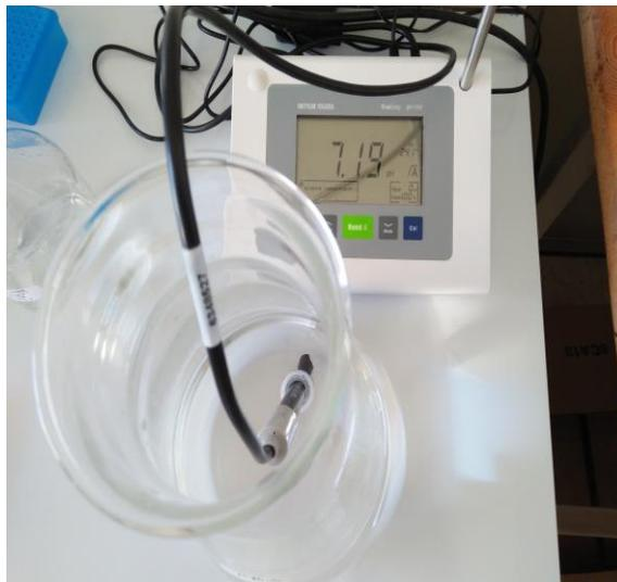
**Figure 4 :** La mesure du PH du PBS à l'aide d'un PH-mètre d'où un PH de 7.2 à été ajusté en ajoutant du NaOH.
