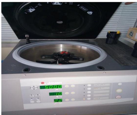
**Figure 9:** Centrifugation des échantillons à 4100tr/mn pendant 10mn avec une centrifugeuse
