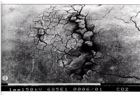
Figure (2.19) : Surface cémentaire lasérisée par CO<sub>2</sub>
