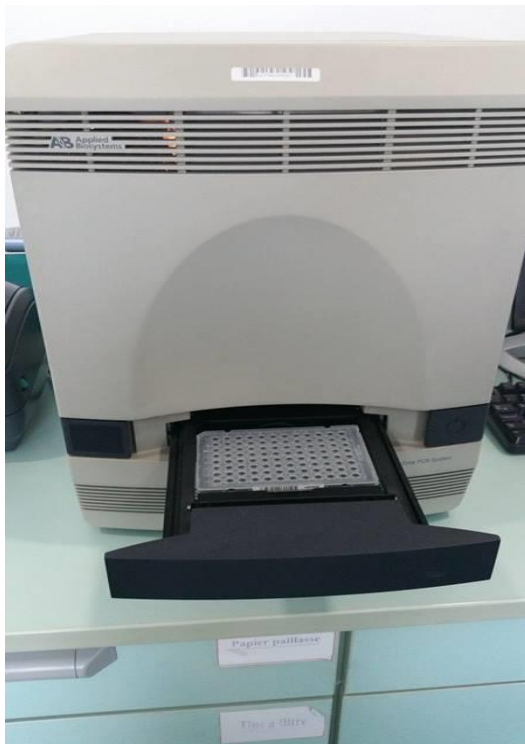
Annexe 6 : System de PCR en temps Réal 7500
