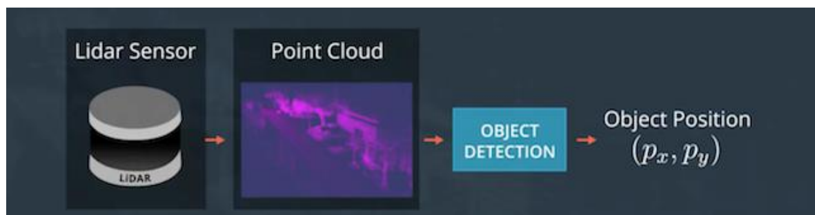
Figure 2.13. Estimation de position avec un Lidar.
