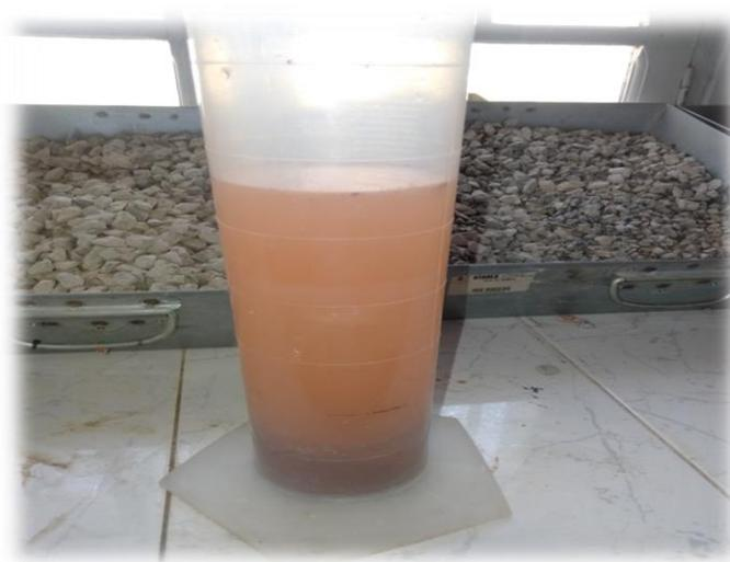
**Figure III.6** : Essai de la masse volumique absolue.
