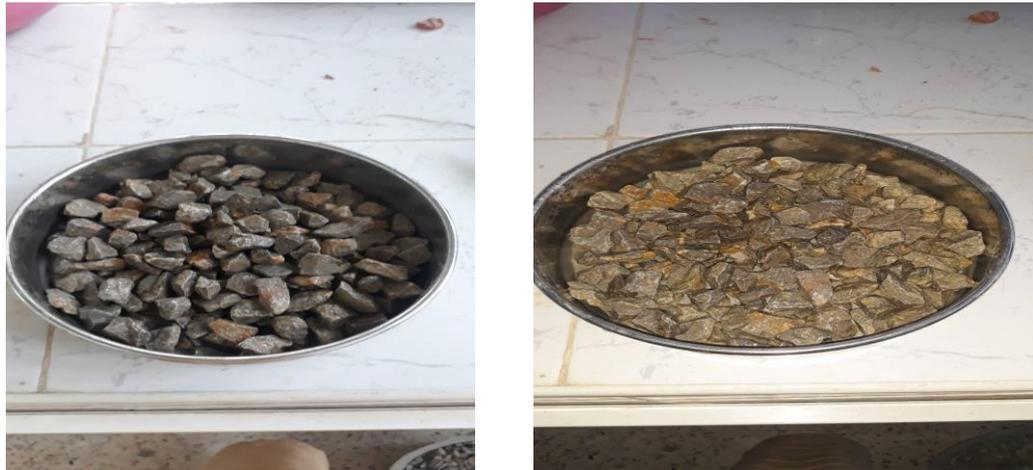
Figure III.9 : La propreté de gravier
