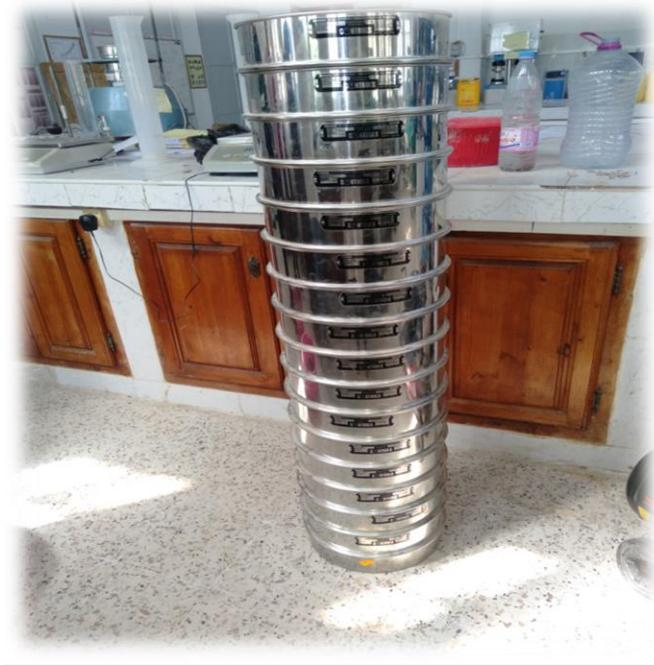
**Figure III.4** : l'essai d'analyse granulométrique.
