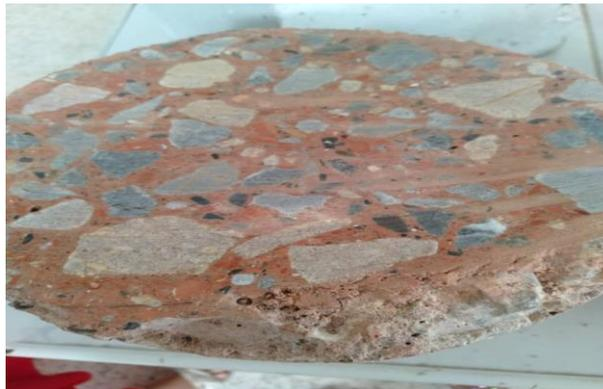
Figure III.30 : Epreuve surfacée.
