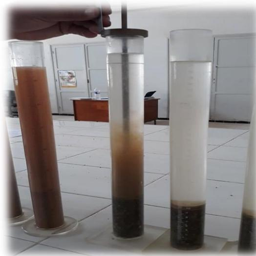
Figure III.7 : Essai d'équivalent de sable.
