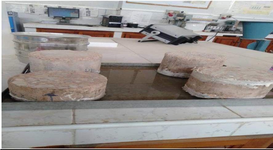
Figure III.28 : L'absorption capillaire.
