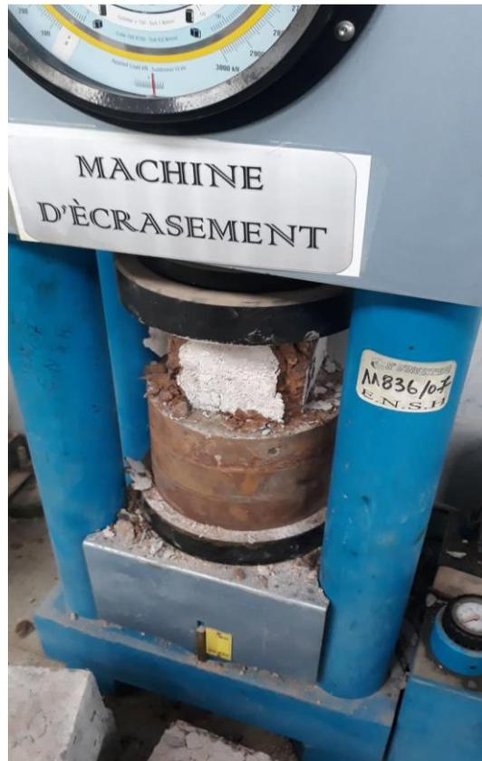
Figure III.25 :L'essai d'écrasement.
