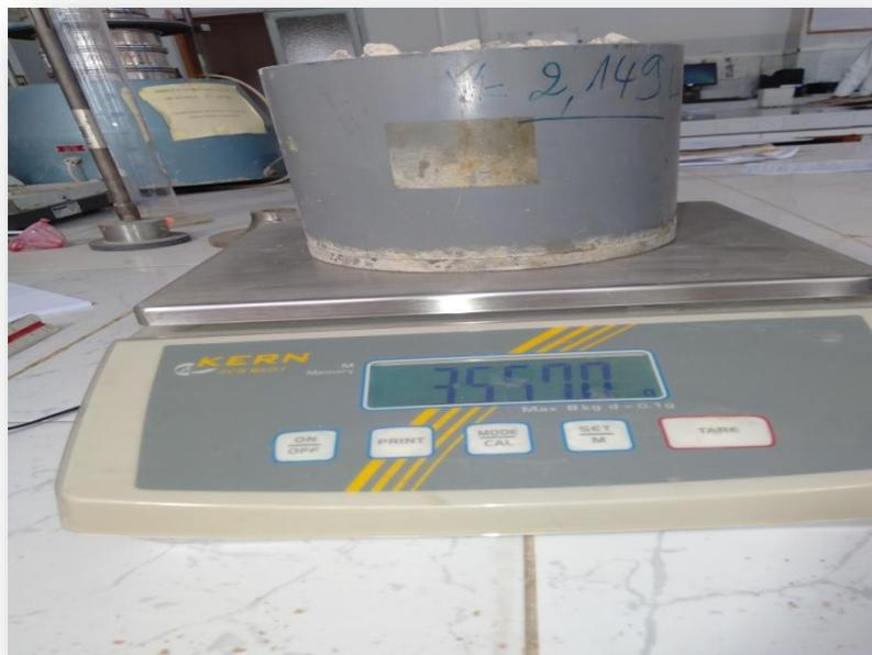
**Figure III.5** : Essai de la masse volumique apparente.
