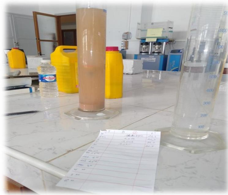
Figure.III.14 : Analyse granulométrique par sédimentation de filler calcaire.
