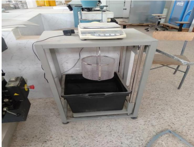
Figure III.29 : Essais de porosité.
