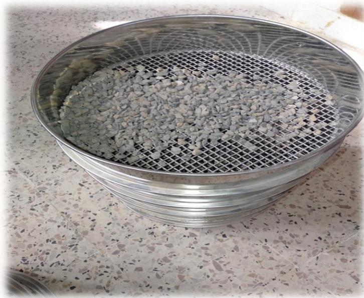
Figure III 11 : Analyse granulométrique de gravier.
