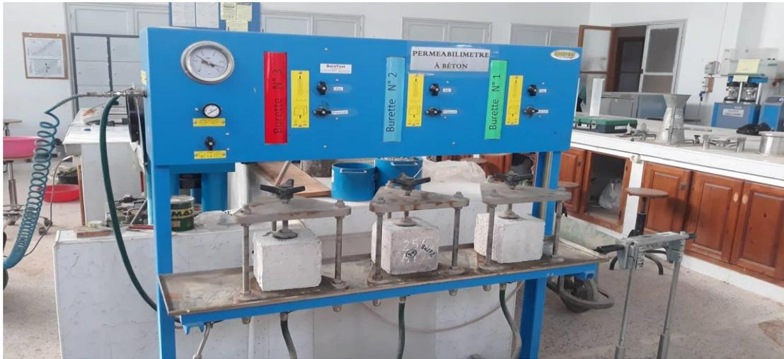
Figure III 32 : perméabilité a l'eau sous pression.
