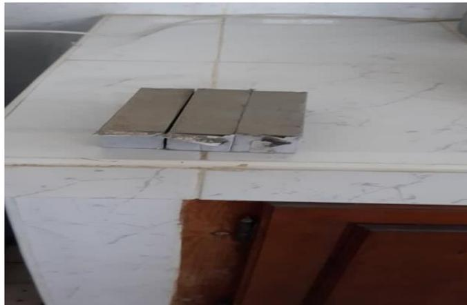
Figure III.17 : Préparation des moules de mortier normalisé.
