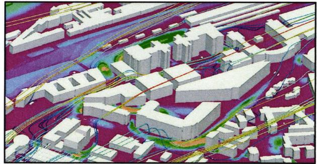
Figure1: Quantification du niveau de confort dans un quartier en fonction des données météorologiques et de la topographie locale. Les zones orange correspondent à des zones souvent inconfortables.
