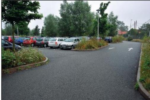
Figure II-100: Chaussée à structure réservoir
