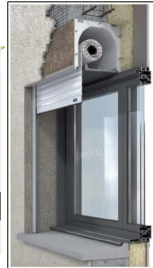
Figure 160: protection solaire par les volets roulants au niveau des ouvertures source (www.viking windows.com)
