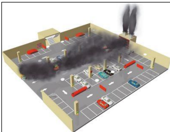
Figure 150: système de désenfumage /source www.pinterest.com )
