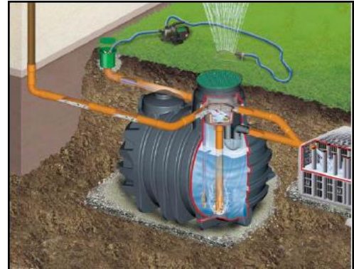
Figure 168: cuve de stockage des eaux pluviale source
