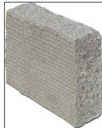
Figure III.15. échantillon de la ouate de cellulose
