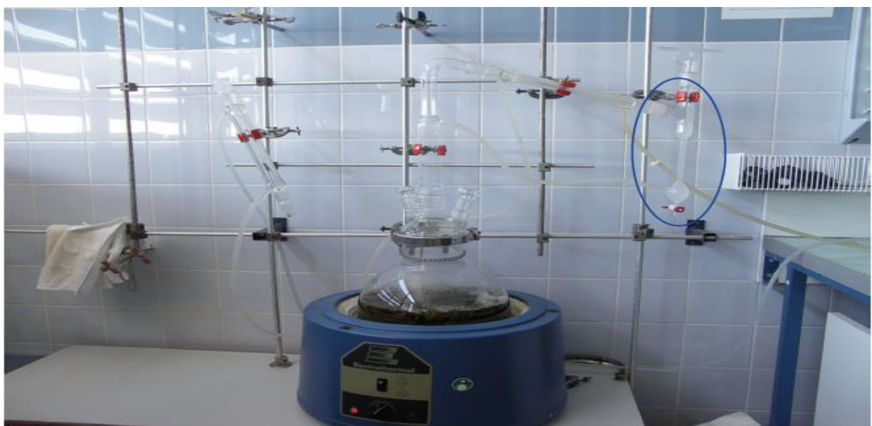
Figure n°5: montage d'hydrodistillation (Clevenger) (Smadja, 2009).
