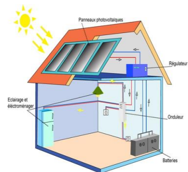
Figure 24 : principes de l'architecture bioclimatique active source( https://fr.pinterest.com/pin/409686897332812796/ )
