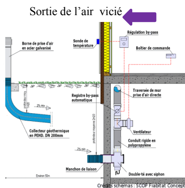
Figure 173:: La gestion des condensats source : http://www.fiabitat.com/dimensionner-un-puits-canadien/
