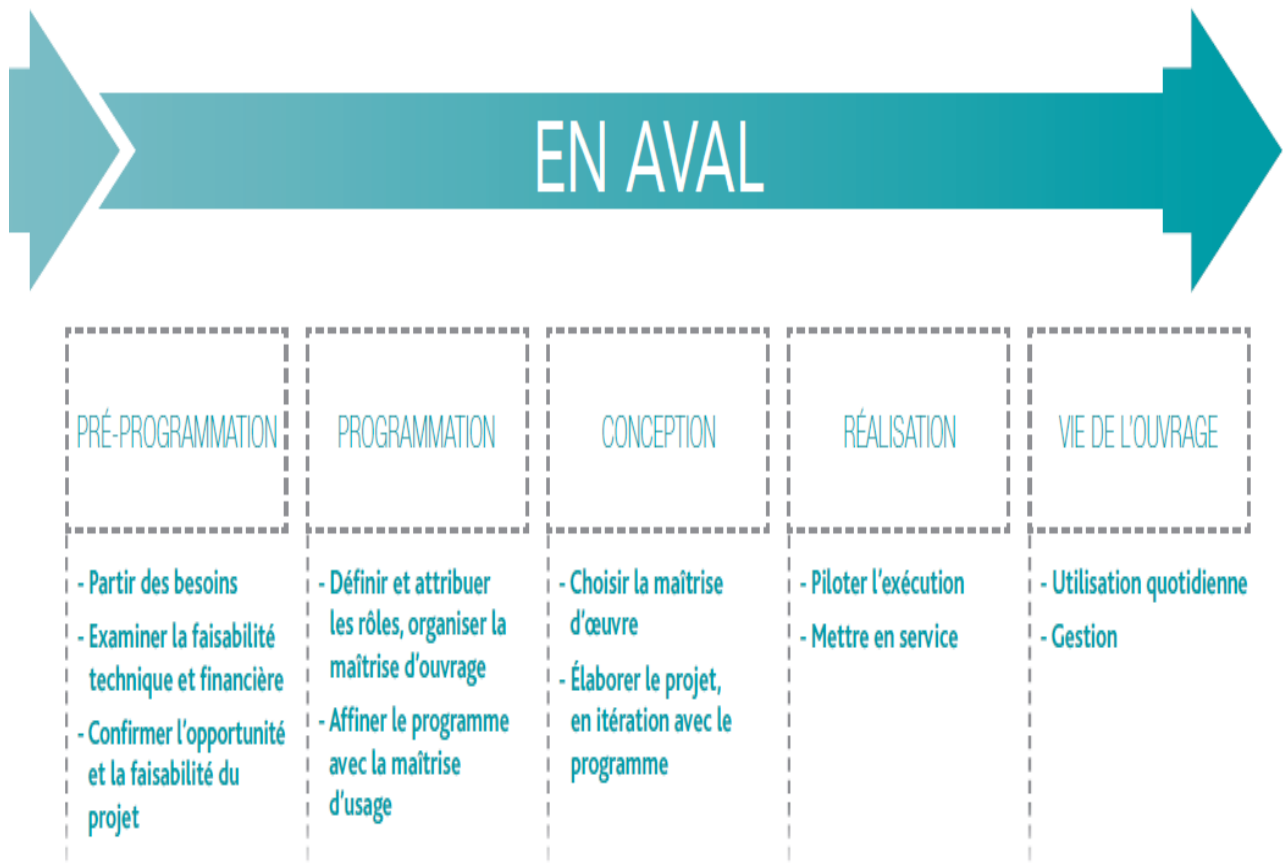
Figure II-8 : Les étapes d'élaboration d'un projet architectural.
