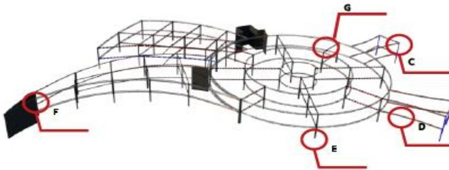
■ Des poteaux métallique cylindrique ■ Le profilé IPE ■ poutres alvéolaires
