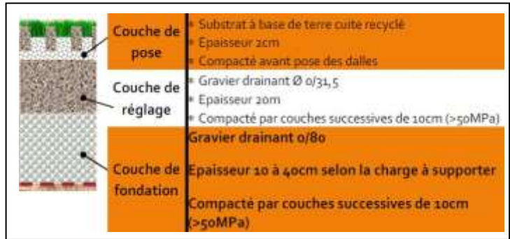
Figure 121 : Exemple de mise en œuvre pour les dalles Evergreen mousse. Source : allée, parkings : revêtement a biodiversité positive. Fichier PDF.
