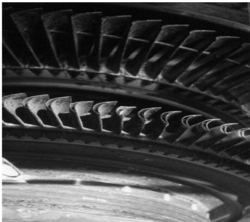
Fig I.11. L'aube de turbine 1er étage creux indiquant refroidissement des aubes et la corrosion, tant sur le 1er et les lames 2ème étape. [16]
