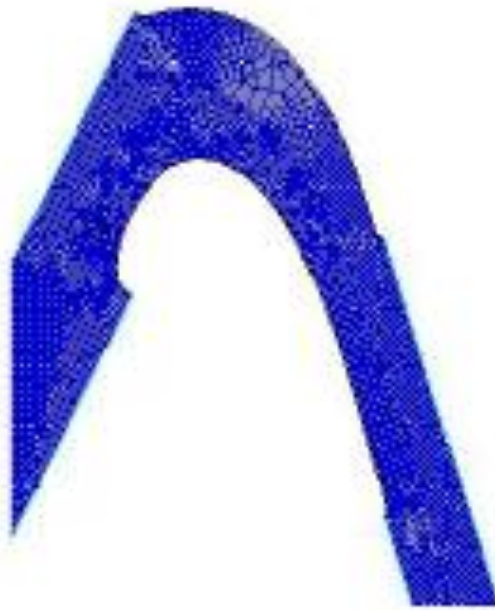
Fig. III.1 Maillage quadratique non structuré - 24900 nœuds
