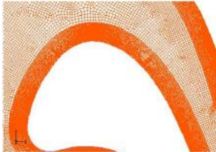
Fig. III.3 Maillage de type O – 85116 nœuds pour deux passages
