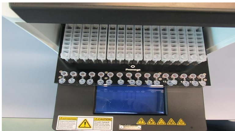
Figure 14 : Rack contenant les cartouches placé à la plateforme Maxwell®16
