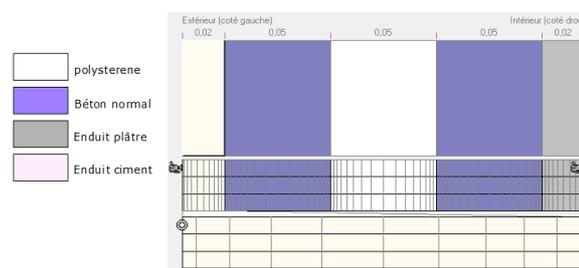
**Figure III-50: isolant au milieu ép. = 5 cm**
