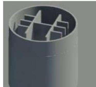
C'est un système qui repose sur l'existence d'un massif noyau de béton armé au cœur du bâtiment ; c'est-à-dire un énorme pilier en béton creux. A l'intérieur de cette ossature sont logés les voies de circulation verticale (les ascenseurs, les escaliers de secours) et les conduites.
