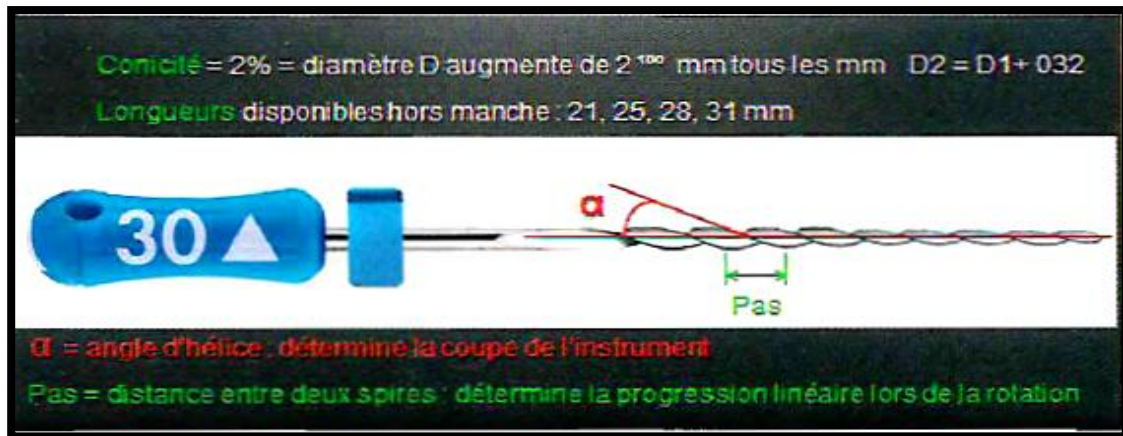
Fig 40: \alpha = Angle d'hélice, Pas = Distance entre deux spires [58].
