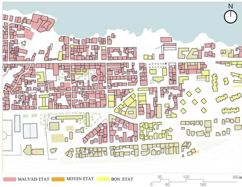
Figure n23 : plan de dégradation du bâti. Source : auteur
