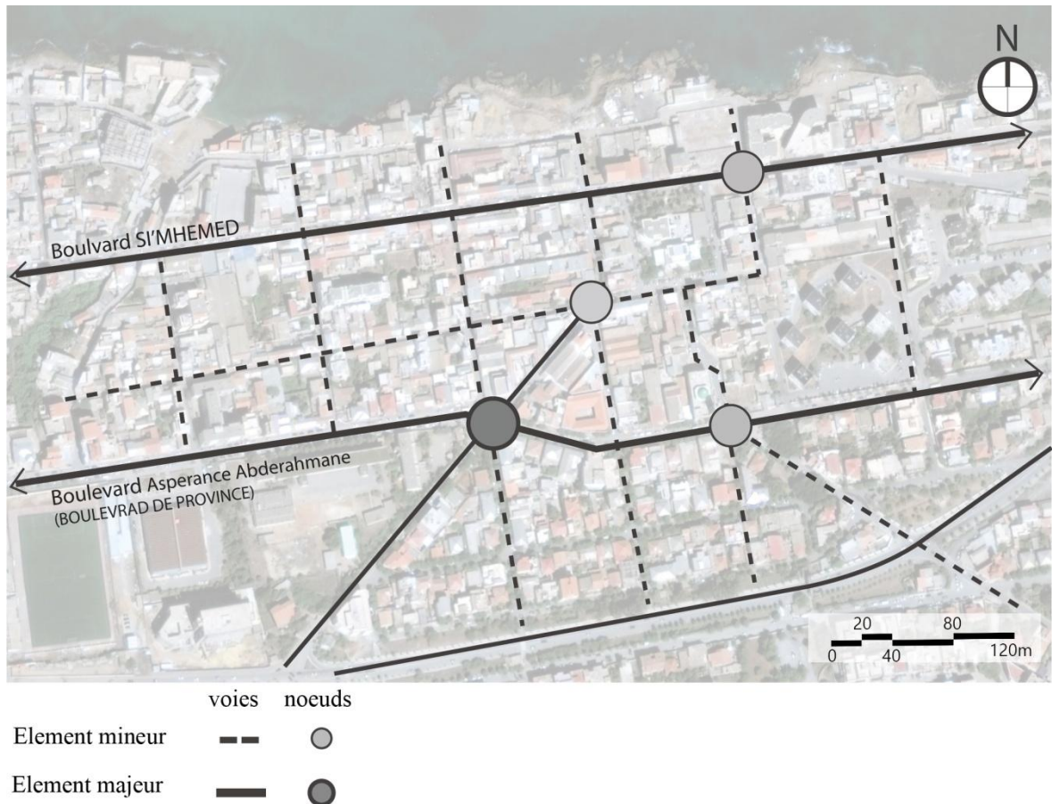
Figure n26 : schéma représente les voies et les nœuds du centre ancien de ain benian,source :auteur
