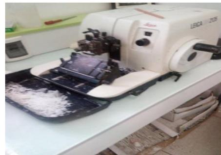
Figure 8.I : Photo d'un microtome
