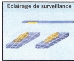
Éclairage à faible puissance orienté au sol ou vers la tête du patient si une surveillance nocturne est nécessaire. (veille)
