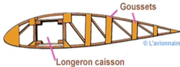
Figure I-9 Schéma détaillé d'une nervure
