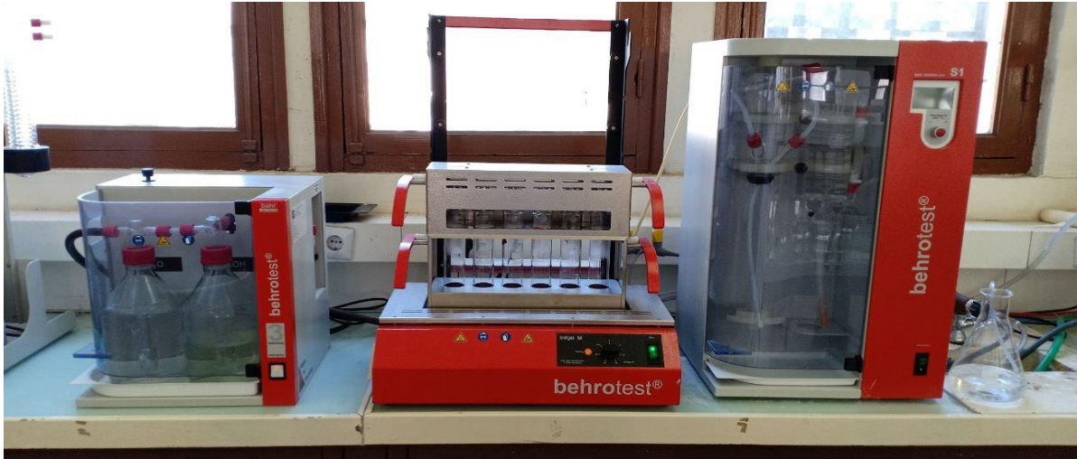
Figure ?.4 : Photo d'un extracteur Kjeldahl (minéralisateur et distillateur)
