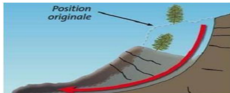
Figure 1.6 : glissement rotationnel simple. [2]
