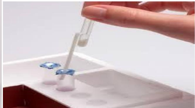
**FIGURE 20 : mettre 0.1 ml de lait dans les tubes ou les ampoules**
