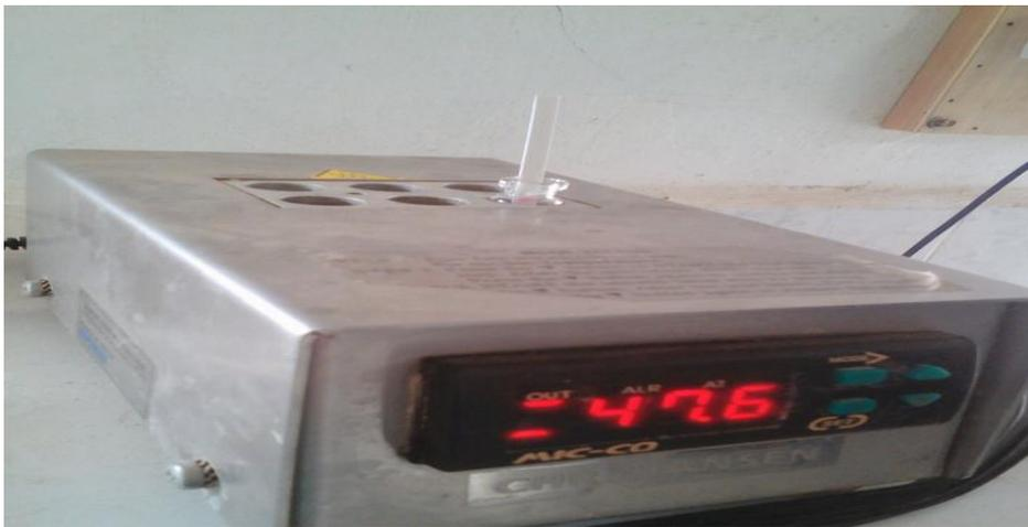
**FIGURE 14 : mettre la bandelette dans le tube après avoir été réchauffé et le régler pour 10 minutes d'incubation**
