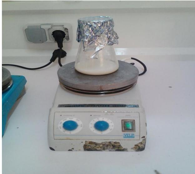
**FIGURE 28 : le test d'ébullition**
