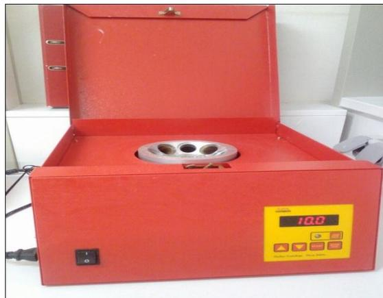
**FIGURE 32 : Butyromètre et la centrifuge**
