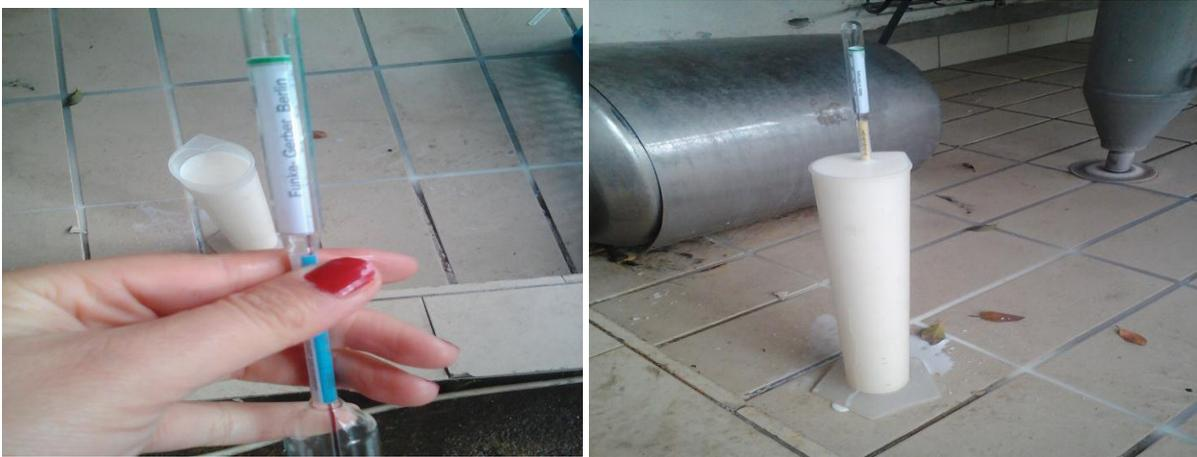
**FIGURE 34 : l'introduction de lactodensimètre dans l'éprouve**
