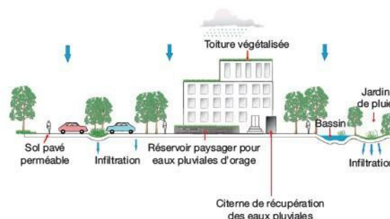
Figure 51 ;la gestion eaux pluviales
