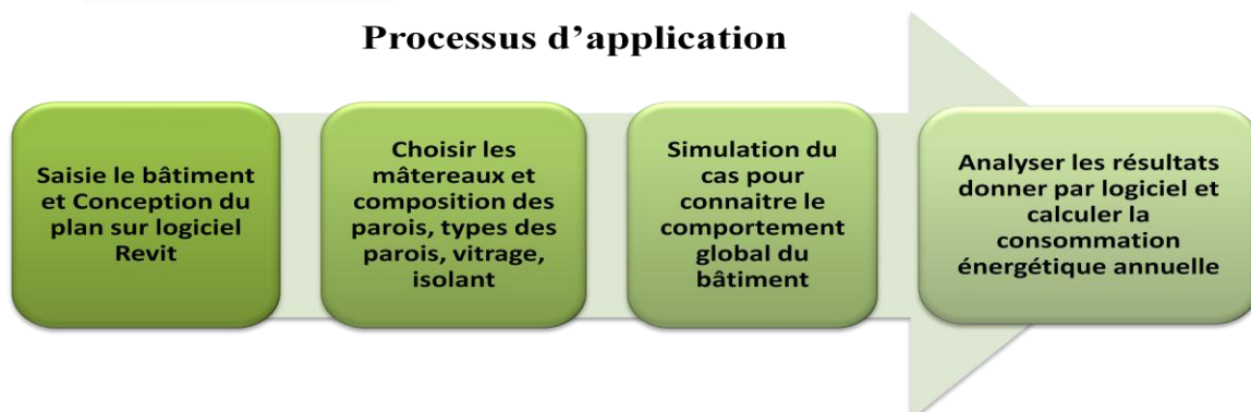
Figure86 :schéma de démarches de simulation
