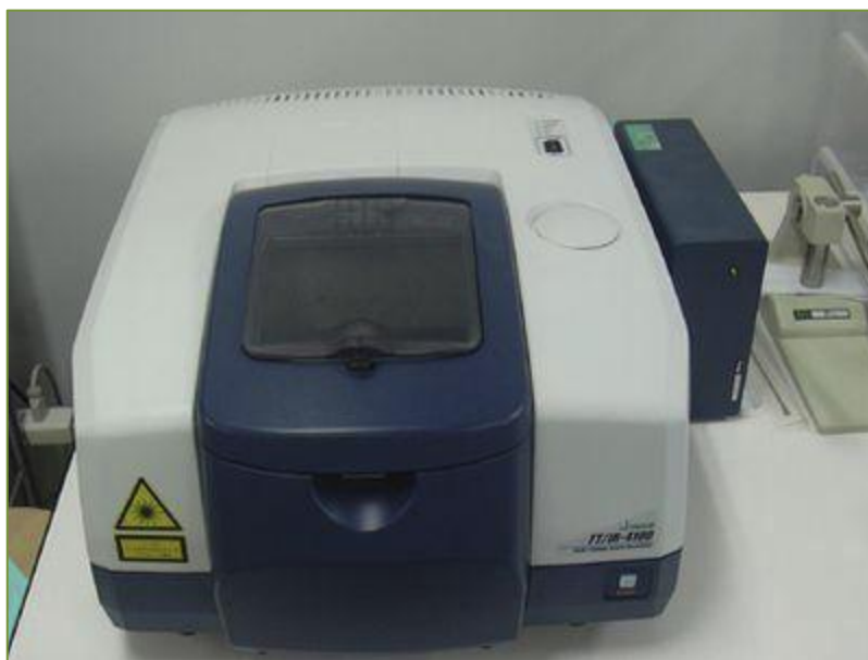
Figure III.2: Photo du spectrophotomètre Infrarouge à Transformée de Fourier utilisé.
