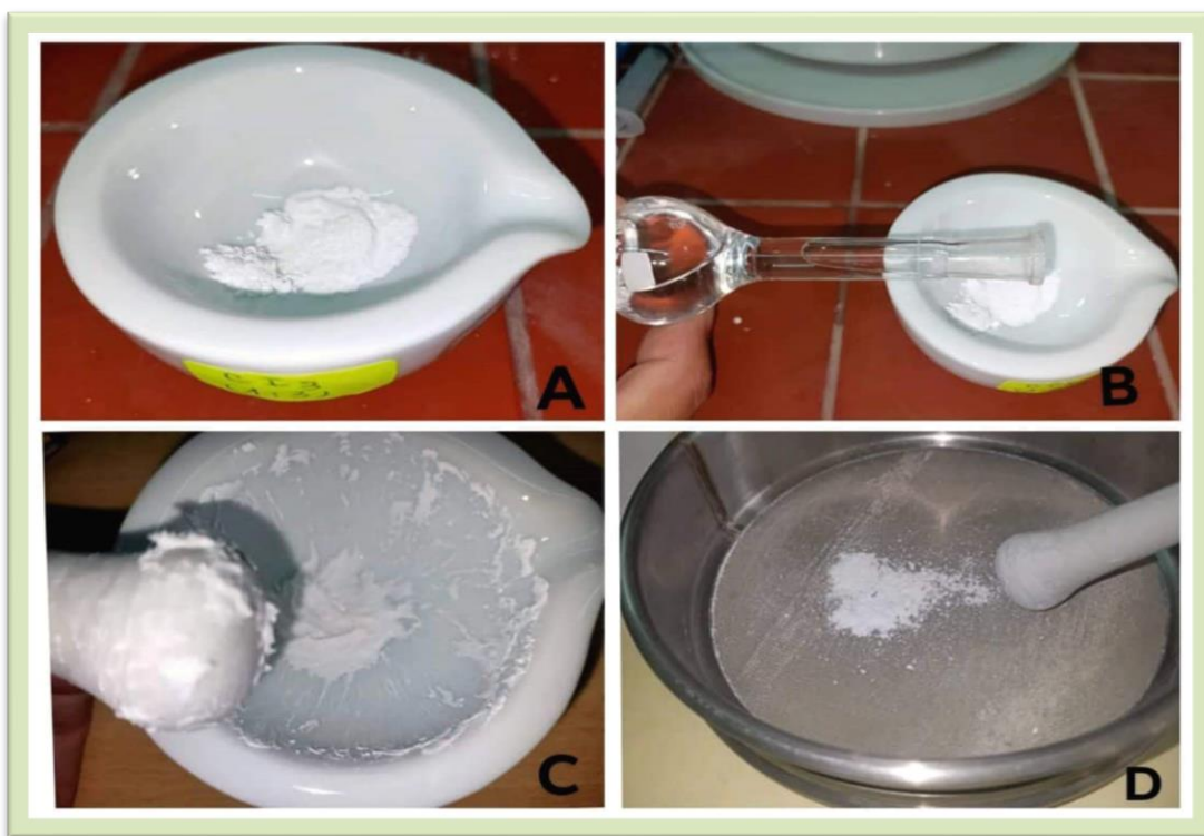
Figure III.6: Les étapes de préparation d'un complexe d'inclusion
