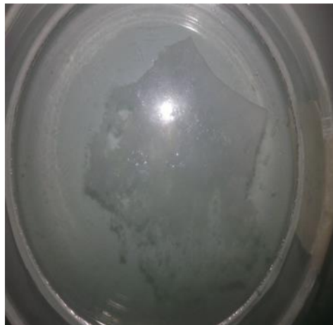
Figure IV.10: Image montrant la désintégration du film dans la solution tampon à pH 6,8
