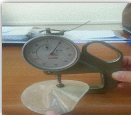
Figure III.9: Détermination de l'épaisseur par un micromètre.
