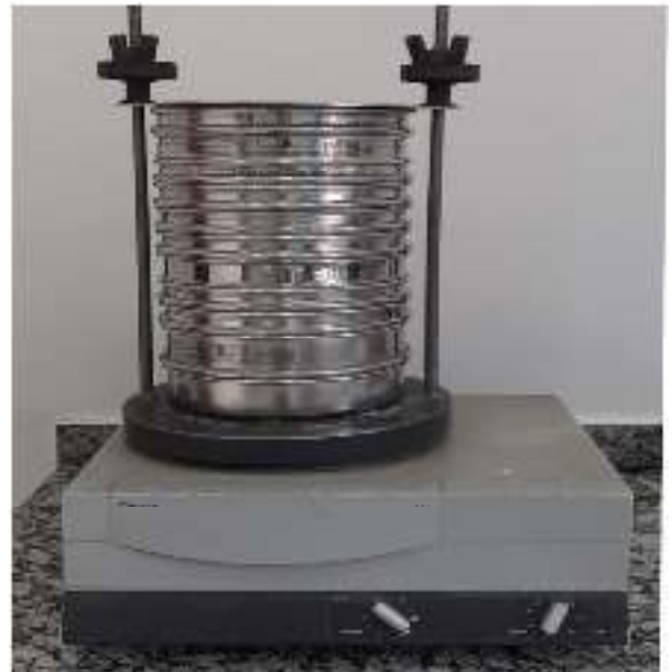
Plansichter avec tamis « granulométrique »
