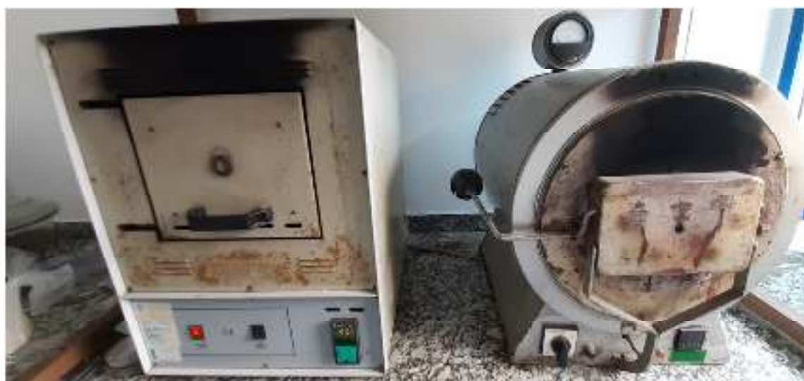
Four à moufle pour le dosage de l'eau le dosage des cendres
