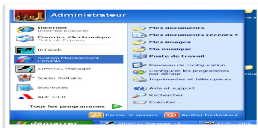
Figure IV .7. Logiciel de communication entre intouch et l'automate.
