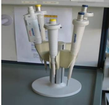
Micropipettes pouvant distribuer un volume de 5 à 1000 \mu l
