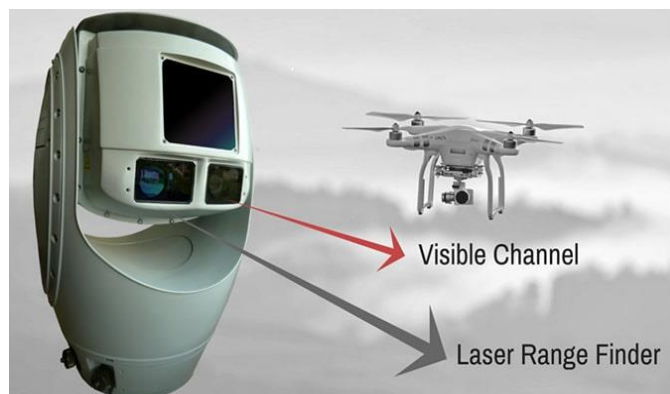
Figure 1. 19: Système de détection de drones par Caméras électro-optiques (EO) [14].
