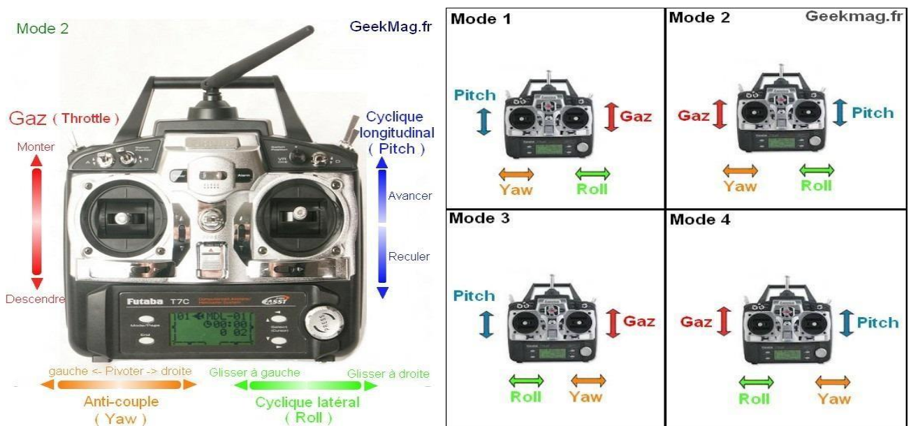
Figure 1. 16: Principe de fonctionnement d'une radiocommande. [7]
