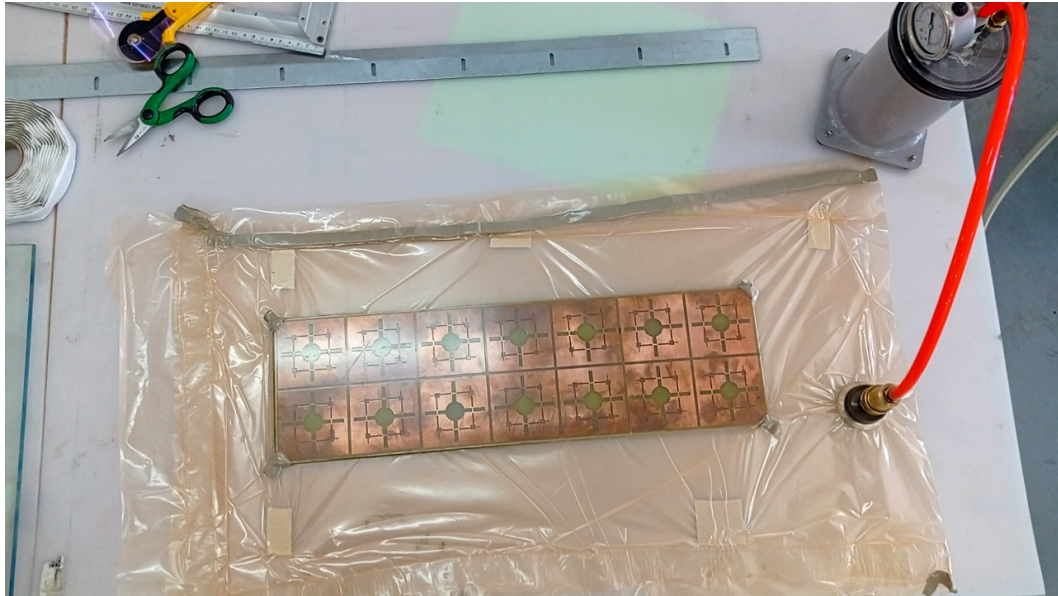
FIGURE 4.15 – application de sous vide.
