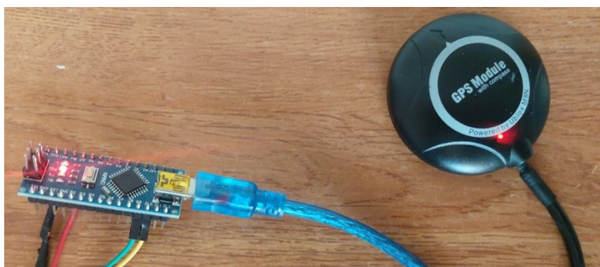
Figure III-22 connecte le capteur GPS u-blox M8N avec Arduino NANO.
