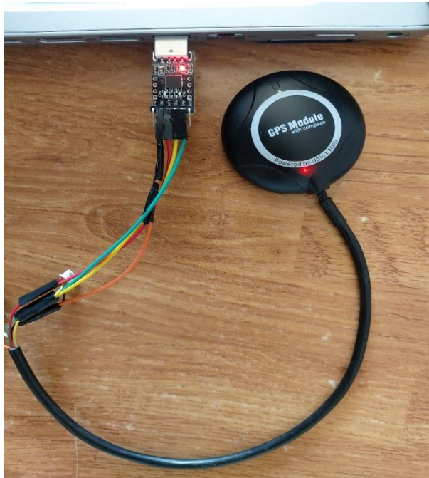
Figure III-18 connecte le capteur GPS u-blox M8N avec Le module convertisseur USB vers TTL CP2102.
