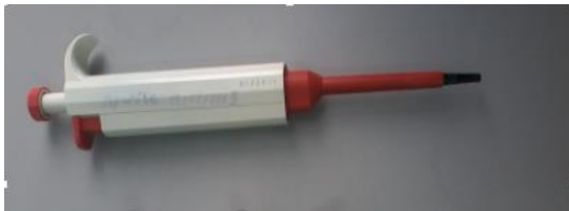
Figure 25 : Pipette semi-automatique de (500 µl) (Photo originale)
