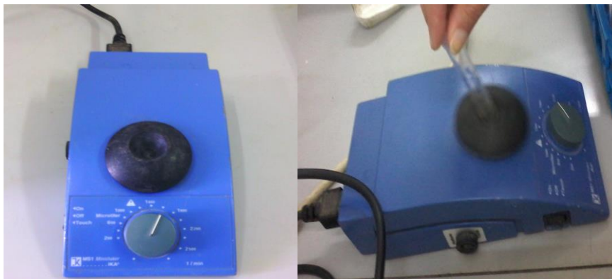
Figure 26 : Agitateur à mouvement de va et vient horizontal ou à plateau oscillant (Photo originale)
