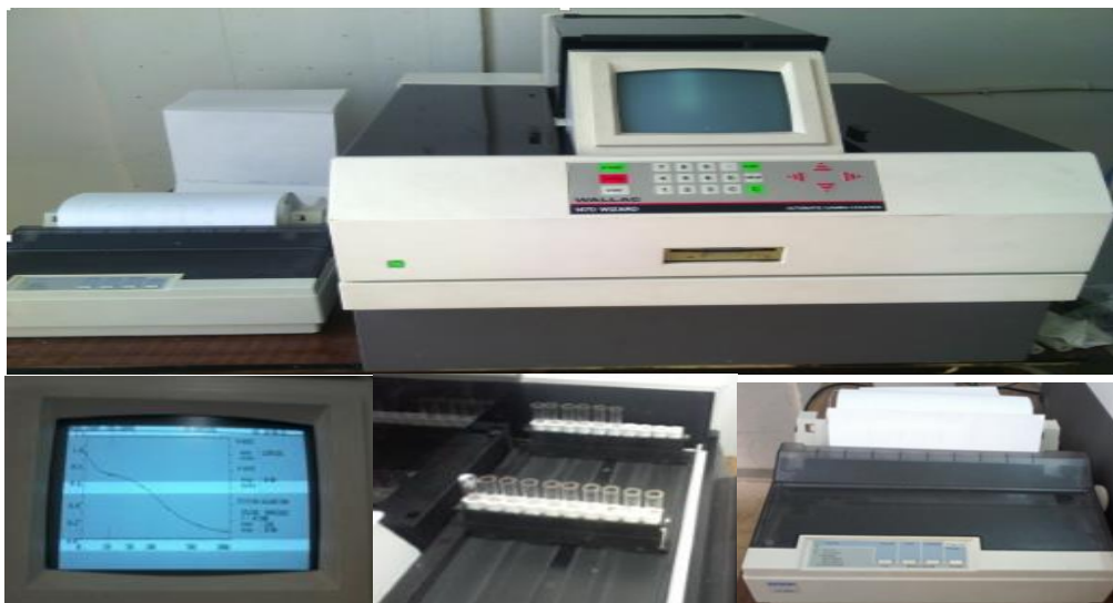
Figure 29 : Compteur gamma réglé pour la mesure de l'Iode 125 (photo originale)
