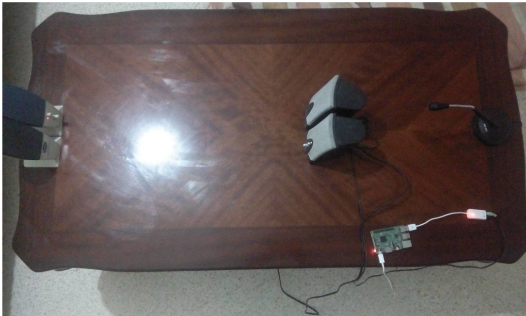
Figure 5.14 : Réalisation de système ANC sans le PC.
