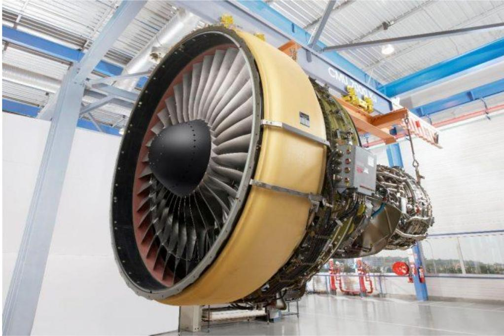
Figure IV.15 :Image réelle du turboréacteur CF6-80-E1
