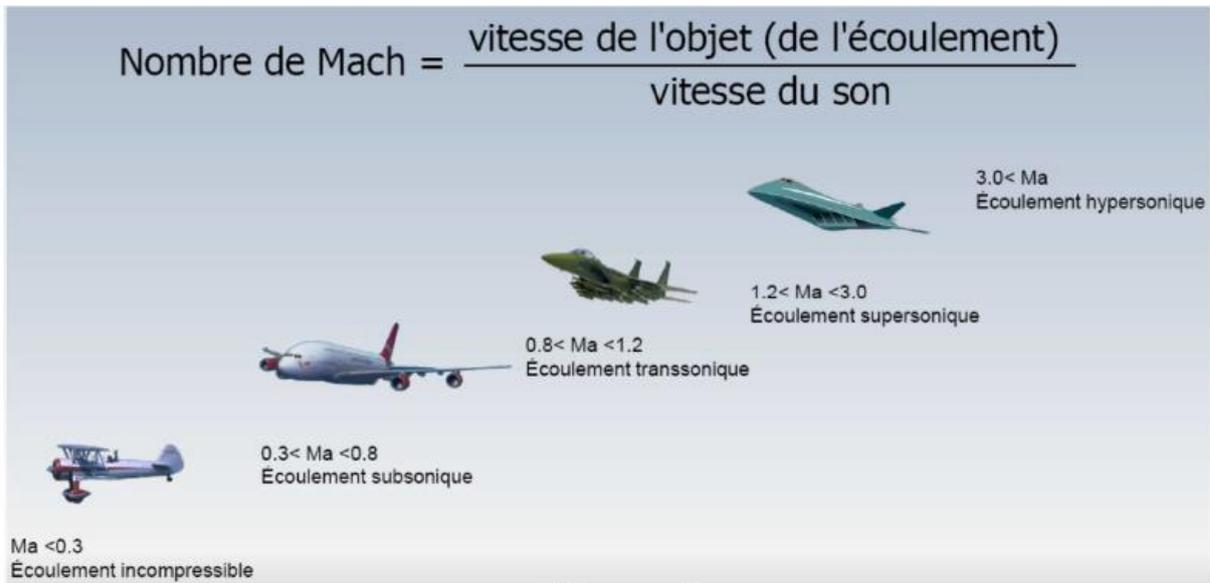
Figure II.1 : Les différents régimes d'écoulement
