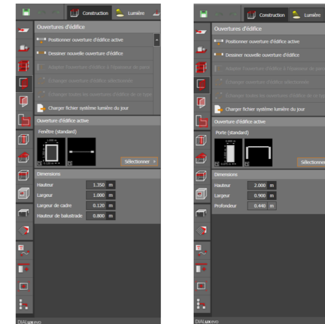
Figure 6.54 : Dimensionnements des portes et des fenêtres sur DIALUX Evo. Source : Auteur année 2020.
