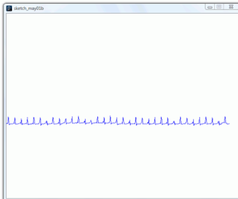
FigureIII.6 Réponse du capteur à une distance fixe.
